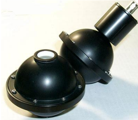
圖三：積分球與偵測器組合之實體照片
